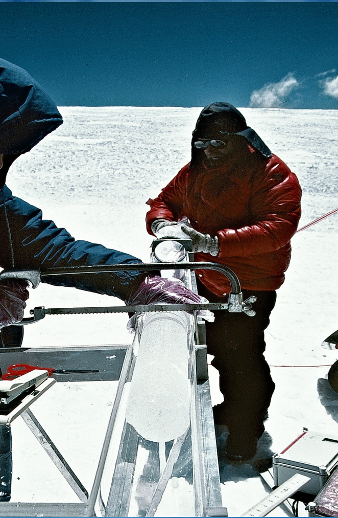
Preparación de las muestras de testigos de hielo, tomadas en glaciares
