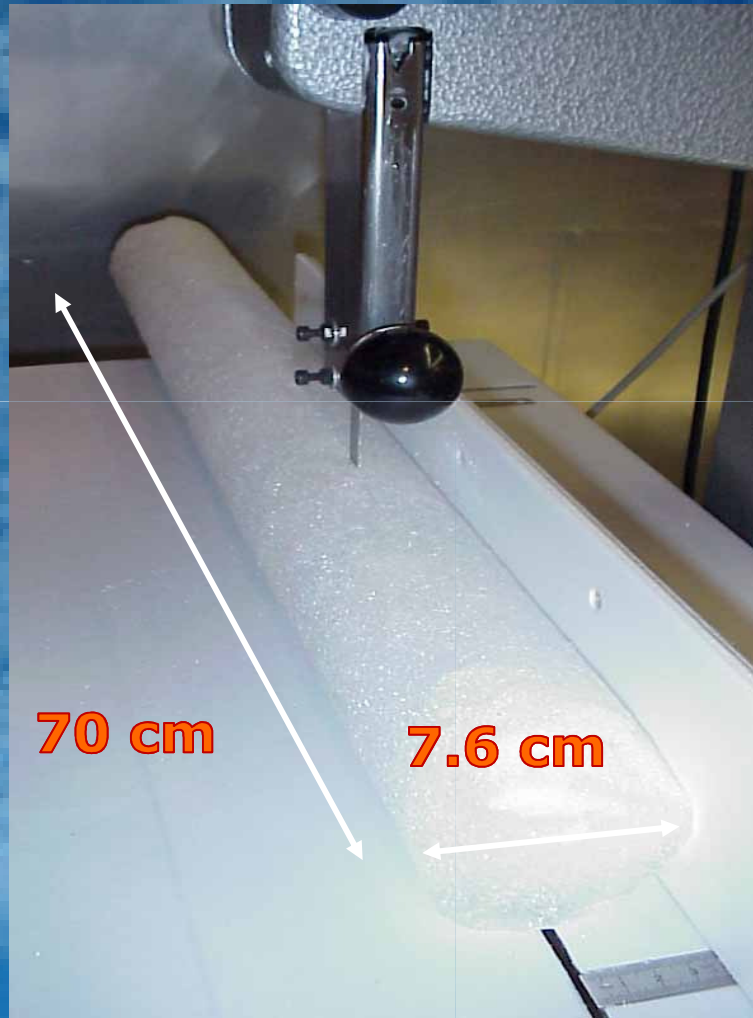
Preparación de las muestras de testigos de hielo, tomadas en glaciares
