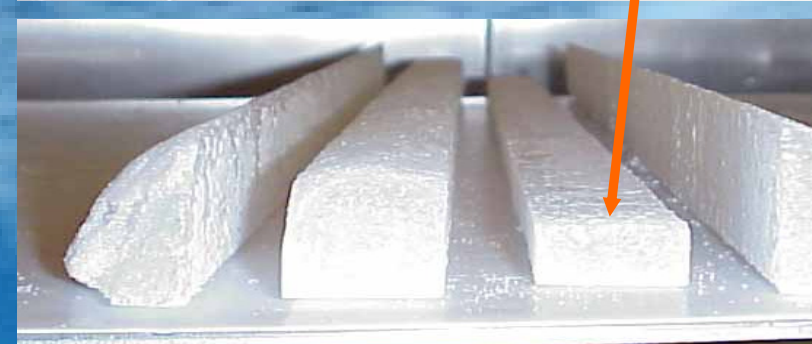
Preparación de las muestras de testigos de hielo, tomadas en glaciares
