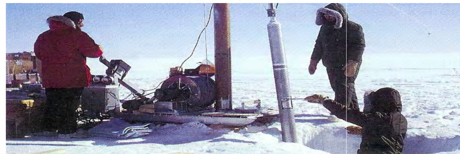
Perforaciones en el casquete de hielo de Groenlandia hasta llegar al lecho rocoso
