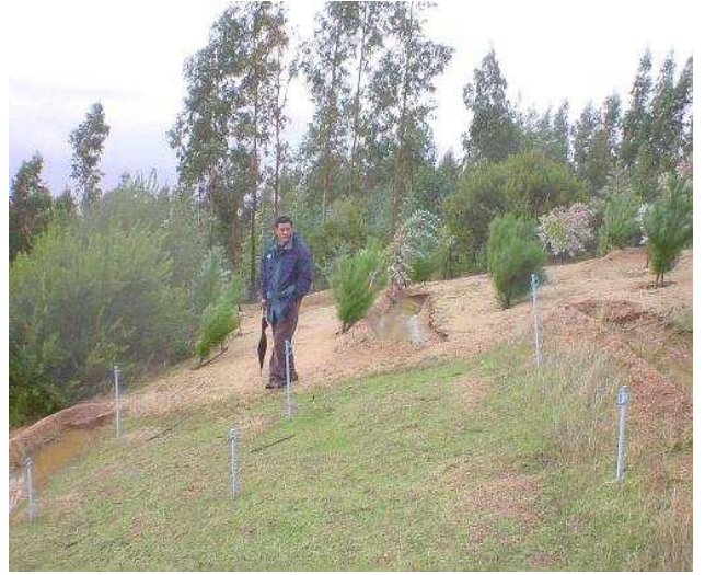
Fotografía 36. Puntos de control de humedad edáfica, zona testigo y zanjas de infiltración. Módulo hidrológico La Gloria, VI Región
