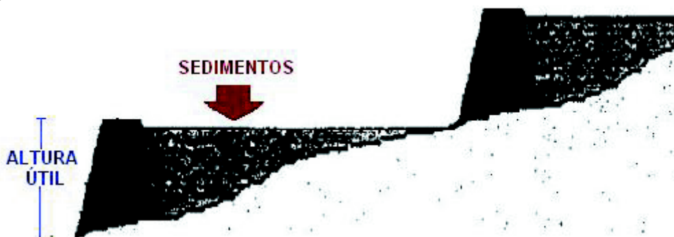
Figura 16. Disposición de diques en ladera
