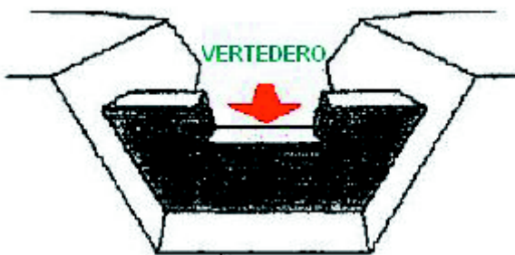
Figura 20. Vertedero de un dique
