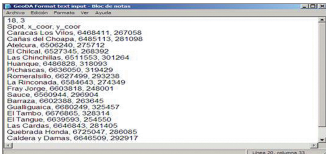
Figura 18: Formato de la entrada de datos del software GeoDa™. Obtenido del software GeoDa™
