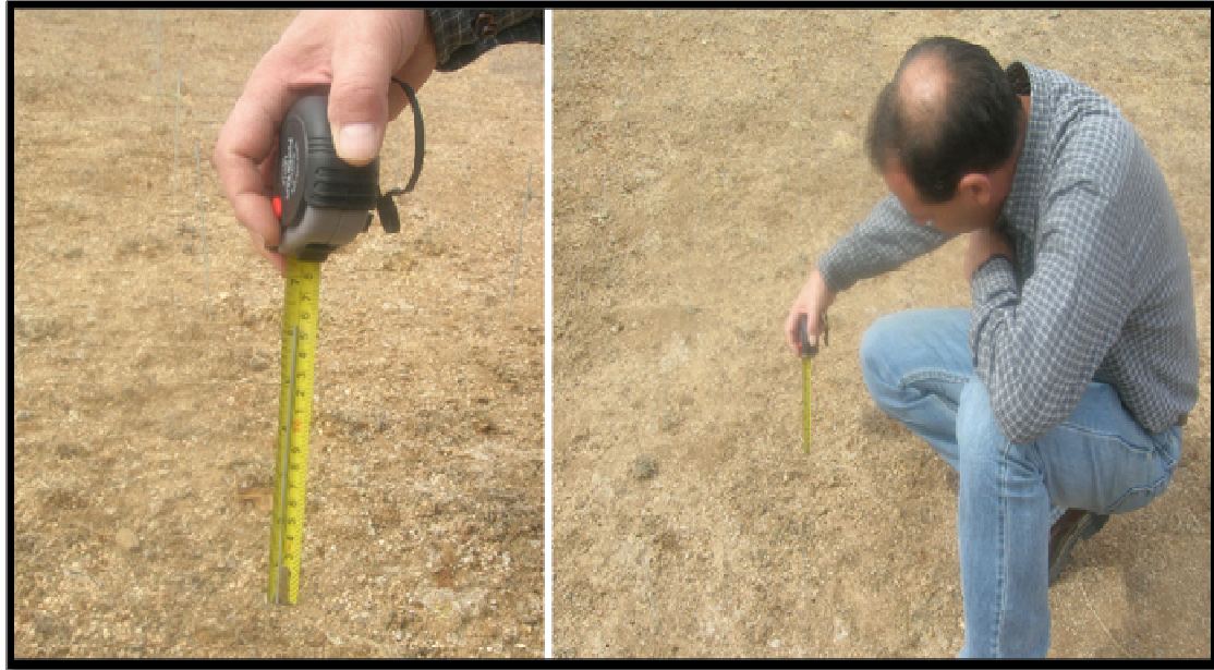
Figura 10. Medición de los clavos de erosión
