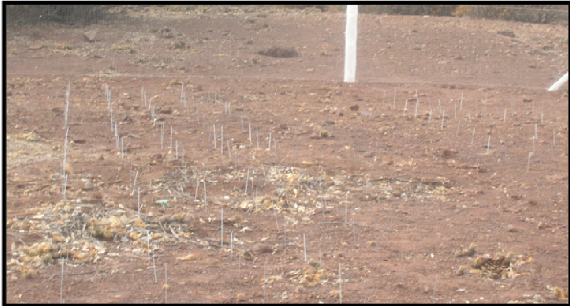
Figura 7. Parcela experimental con clavos de erosión
