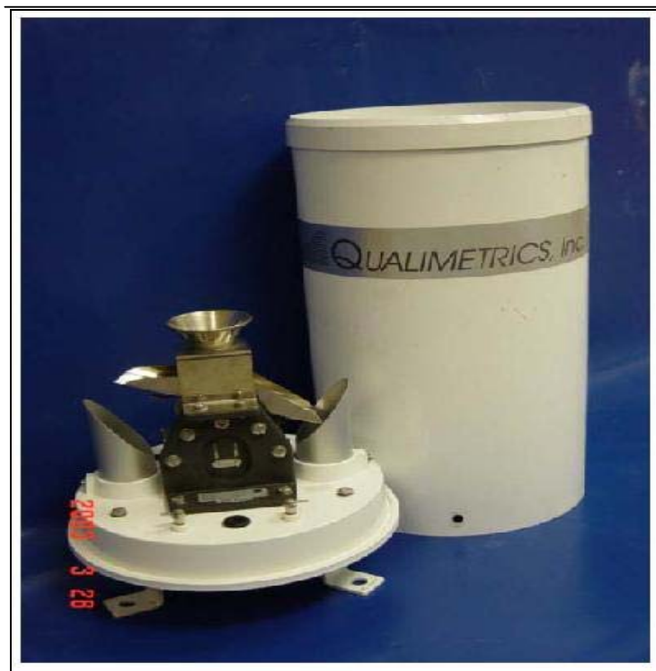
Figura N° 2: Medidor de tipo basculante (Fuente: Ramírez, J. 2004. Apuntes de Hidrología 2004. Disponible en: http://insting.mx1.uabc.mx/~jorger/apuntes_precip_2004.pdf ).
