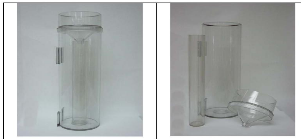
Figura N° 2: Medidor de tipo estándar (Fuente: Ramírez, J. 2004. Apuntes de Hidrología 2004. Disponible en: http://insting.mx1.uabc.mx/~jorger/apuntes_precip_2004.pdf ).
