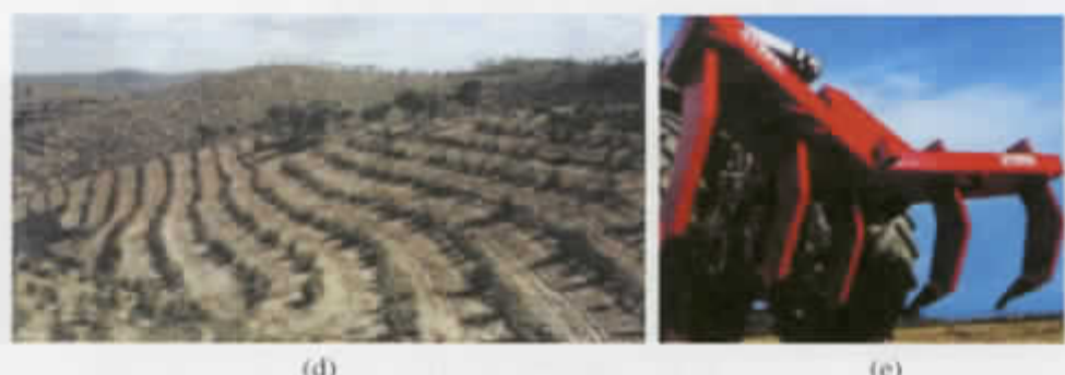
Fotografía 11. (a) Tractor subsolador ( http://agrobyte.lugo.usc.es ) (b) Predio sometido a subsolado para plantación forestal (c) Ripper de subsolado (d) Restauración de ladera erosionada con trabajos de subsolado (e) Vista delantera de un tractor subsolador
